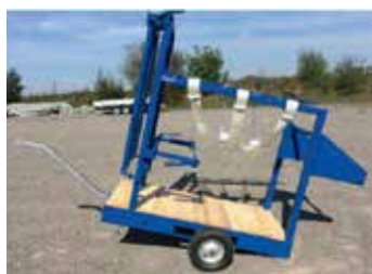
Unterbau mit Wippe Information zur Abbildung: der Unterbau ist neu verzinkt und vorne verlängert (gleich wie bei der Version mit Gabelstapler-Aussparungen).
