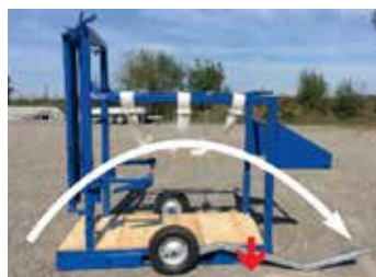
Unterbau mit Wippe Information zur Abbildung: der Unterbau ist neu verzinkt und vorne verlängert (gleich wie bei der Version mit Gabelstapler-Aussparungen).
