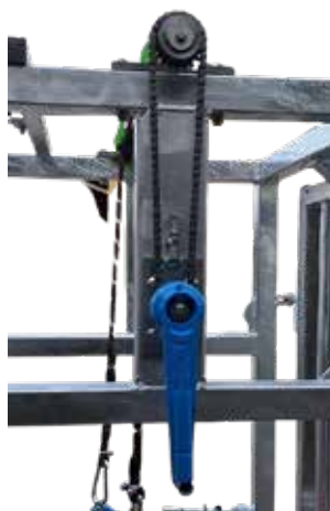
Detail: Antrieb Bauchgurte - manuel
