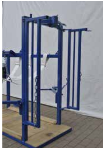
Selbstfangtüren nach aussen geöffnet
