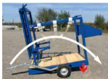
Unterbau mit Wippe Information zur Abbildung: der Unterbau ist neu verzinkt und vorne verlängert (gleich wie bei der Version mit Gabelstapler-Aussparungen).
